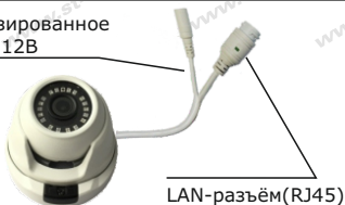
Рис. 1 Схема подключения видеокмеры
